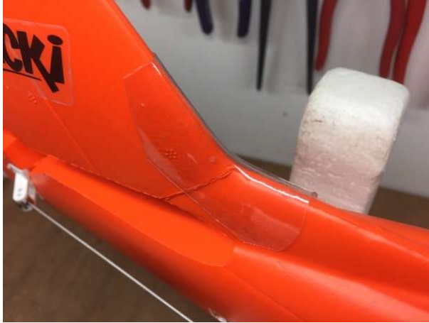
Le renfort n°2 posé à blanc sur le pied de dérive...
